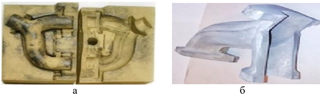
Рисунок 3 – безопочная стержневая форма (а), чугунная отливка (б)
