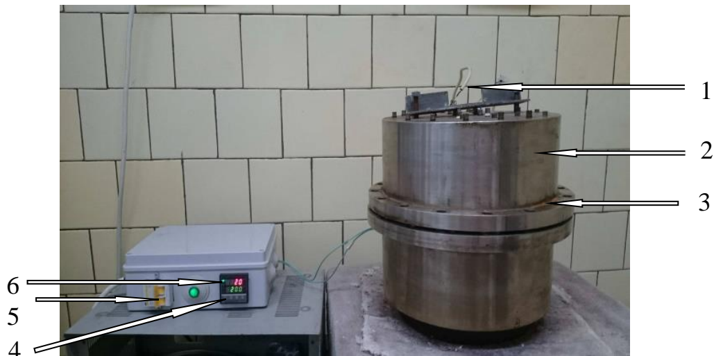
Рисунок 34 – Внешний вид автоклава: 1 - термопара, 2 - корпус, 3 - соединительный фланец, 4 - индикатор заданной температуры на блоке управления, 5 - выключатель, 6 – индикатор текущей температуры
