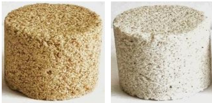
Рисунок 49 – Внешний вид образцов ХТС с добавкой измельченной рисовой шелухи (отформованного) и (термообработанного)
