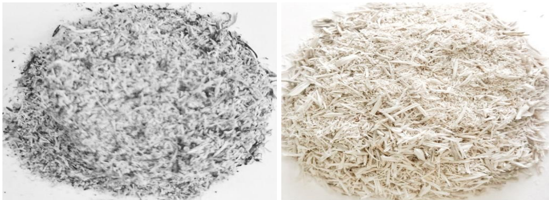
Рисунок 18 – Внешний вид образцов золы РШ, полученных обжигом при температуре 600 °С
