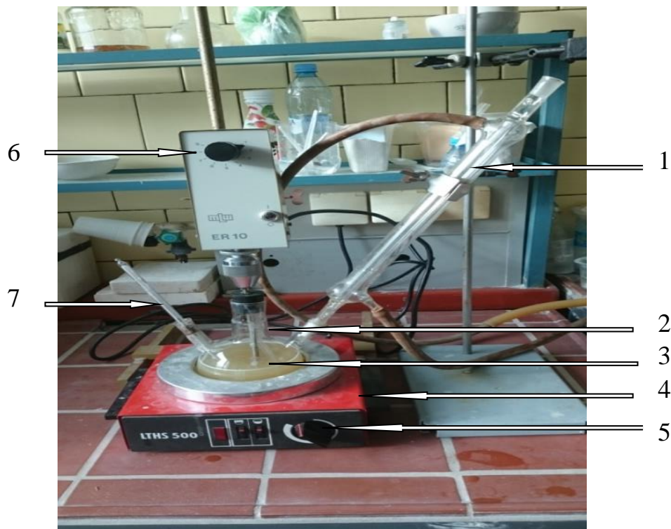
Рисунок 35 – Внешний вид реактора для получения жидкого стекла безавтоклавным способом: 1 – холодильник, 2 – колба, 3 – смесь раствора щелочи с кремнеземом, 4 – электроплитка, 5 – регулятор мощности, 6 – погружная мешалка с приводом, 7 – термометр
