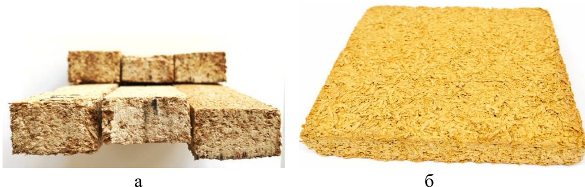
Рисунок 59 – Образцы, полученные из рисовой шелухи, а – на прочность при изгибе, б – на теплопроводность
