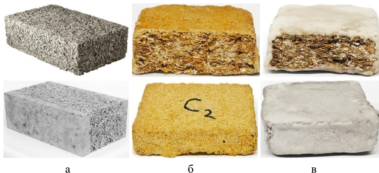
Рисунок 57 – Внешний вид теплоизоляционных материалов: а – арболит, б – полученные образцы с покрытием содержащим ПРШ, в – образцы с покрытием без ПРШ
