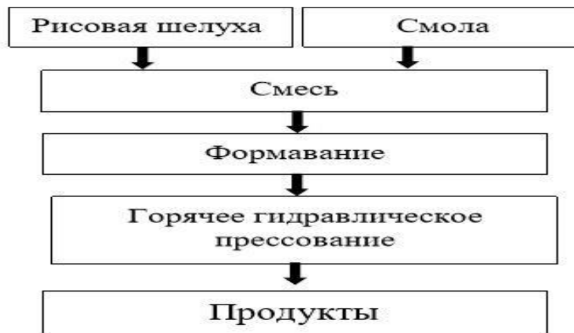
Рисунок 14 – Схема производственного процесса ДСП [138]
