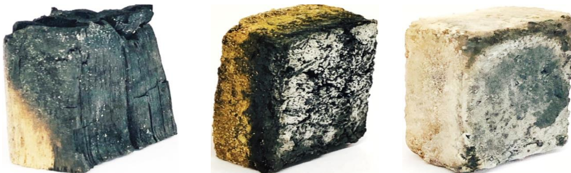
Рисунок 61 – Внешний вид образцов после испытания открытым пламенем, а - древесина, б - непокрытый образец, в - образец с покрытием
