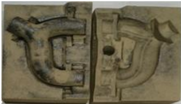
Рисунок 47 – Половины безопасной стержневой формы полученные из жидкостекольной смеси
