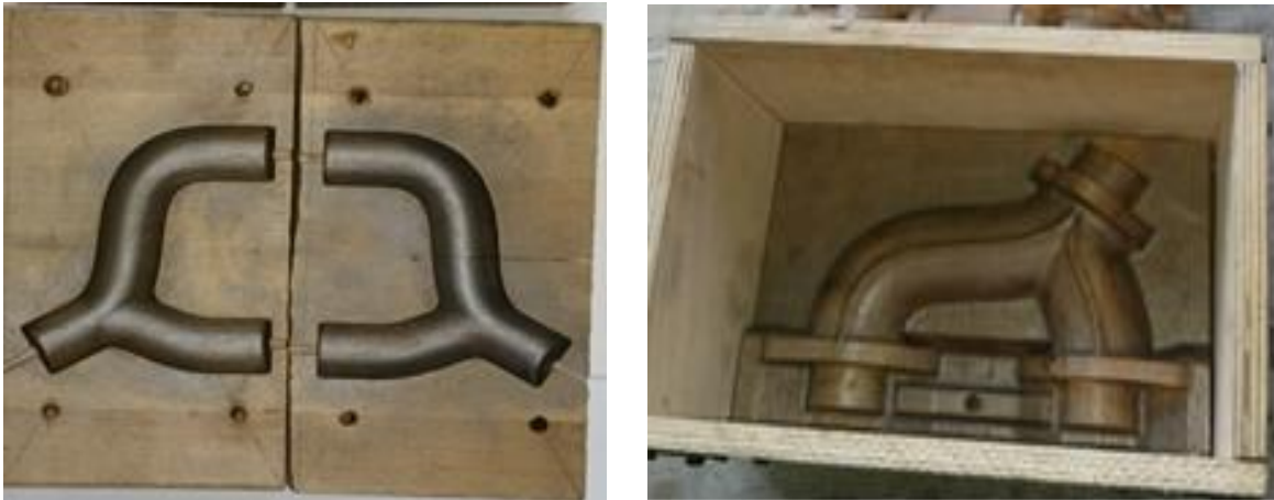
Рисунок 46 – Элементы литейной оснастки: а – верхняя и нижняя половины стержневого ящика, б – модельная плита верха в жакете
