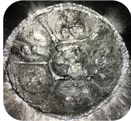
Рисунок 4 - Фотография пластины-свидетеля после взрыва ПВГС с заполненными каналами
