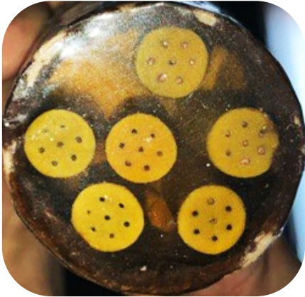
Рисунок 3 - Фотография торца заряда ПВГС на основе ПП марки 14/7 с заполненными каналами
