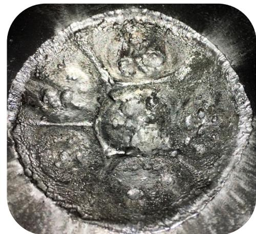
Рисунок 3.21 - Фотография пластины-свидетеля после взрыва ПВГС с заполненными каналами пороховых элементов
