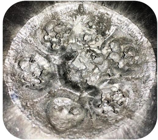
Рисунок 3.19. Фотография пластины-свидетеля после взрыва ПВГС
