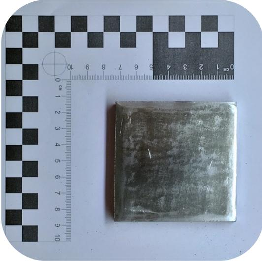
Рисунок 3.3 - Фотография пластины-свидетеля для исследования слеодообразования
