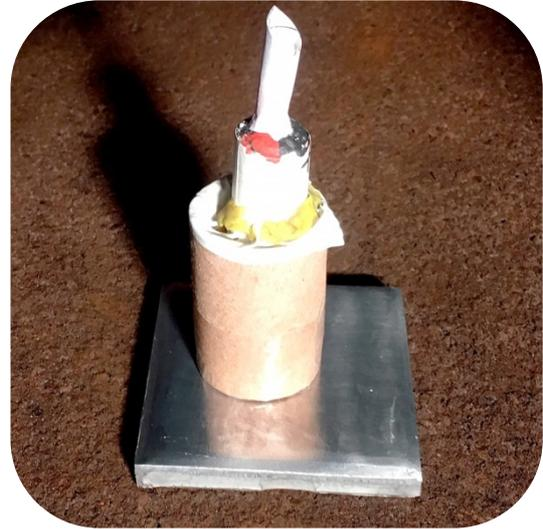
Рисунок 3.4 - Фотография подготовленного к испытаниям заряда ПВГС
