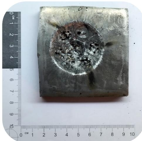
Рисунок 3.5 - Фотография пластины свидетеля после испытаний
