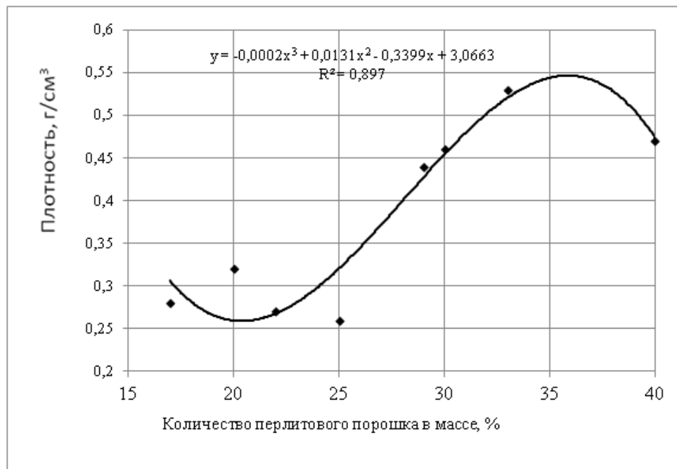
Рис. 3.22. Зависимость кажущейся плотности теплоизоляционного материала на основе вспененного жидкого стекла ( K_v=5 ) с модулем 2,29 и плотностью 1,45 г/см 3 от содержания в массе молотого вспученного перлита
