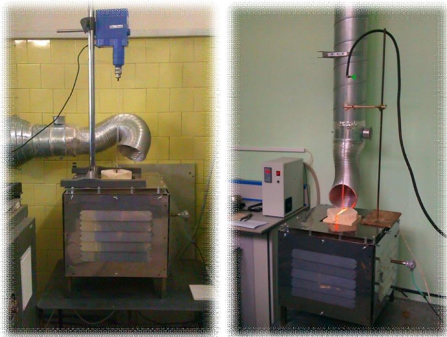
**Рисунок 7. Лабораторная технологическая линия для варки стекол.**
