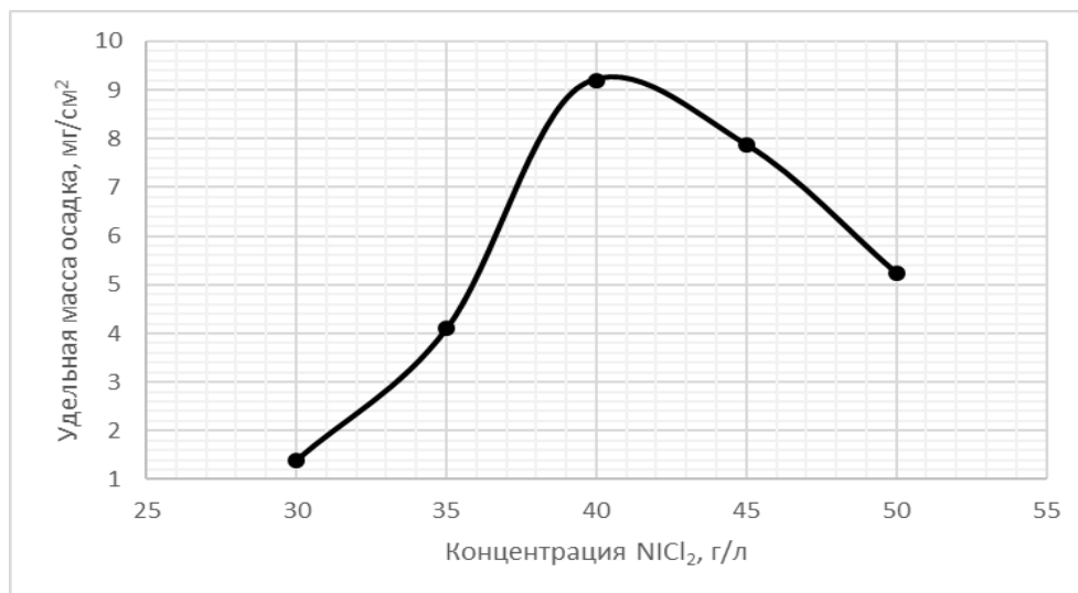
Рисунок 6.2.3. Влияние концентрации хлорида никеля на удельную массу осадка. Раствор: NiCl₂ – 30-50 г/л; NaH₂PO₂ – 40 г/л; NH₄Cl – 45 г/л; NaNO₂ – 0,02 г/л; NH₃*H₂O (25%) – 70 мл/л. pH – 8. Продолжительность процесса 20 минут. Температура процесса 70°C.
