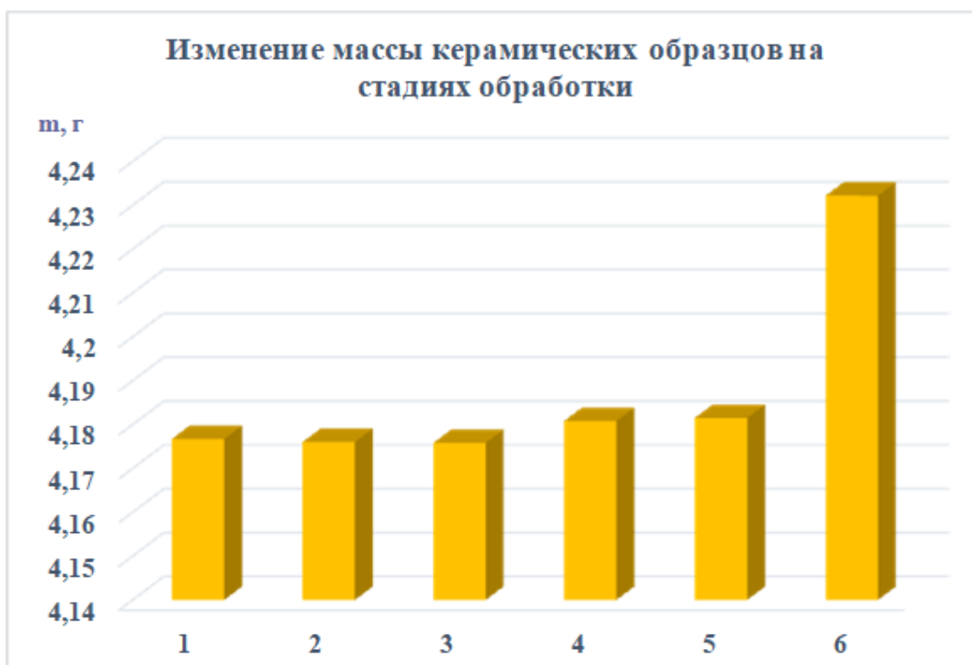
Рисунок 4.4.1 Изменение шероховатости Пв и массы керамических образцов после каждой из стадий обработки при введении стадии акселерации после прямого активирования (1 – исходная поверхность, 2 – обезжиривание, 3 – травление, 4 – прямое активирование, 5 – акселерация, 6 - металлизация). Площадь образцов 13 см 2 .
