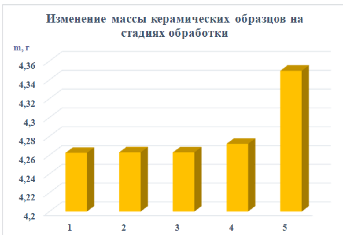
Рисунок 4.3.1. Изменение шероховатости Пв и массы керамических образцов после каждой из стадий обработки при замене двухстадийной активации на прямое активирование (1 – исходная поверхность, 2 – обезжиривание, 3 – травление, 4 – прямое активирование (без акселерации), 5 – металлизация). Площадь образцов 13 см 2 .
