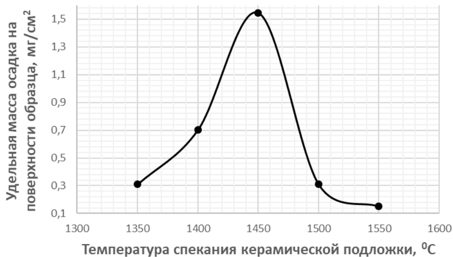
Рисунок 3.1а. Влияние температуры спекания керамических образцов на удельную массу осадка на поверхности образцов после металлизации
