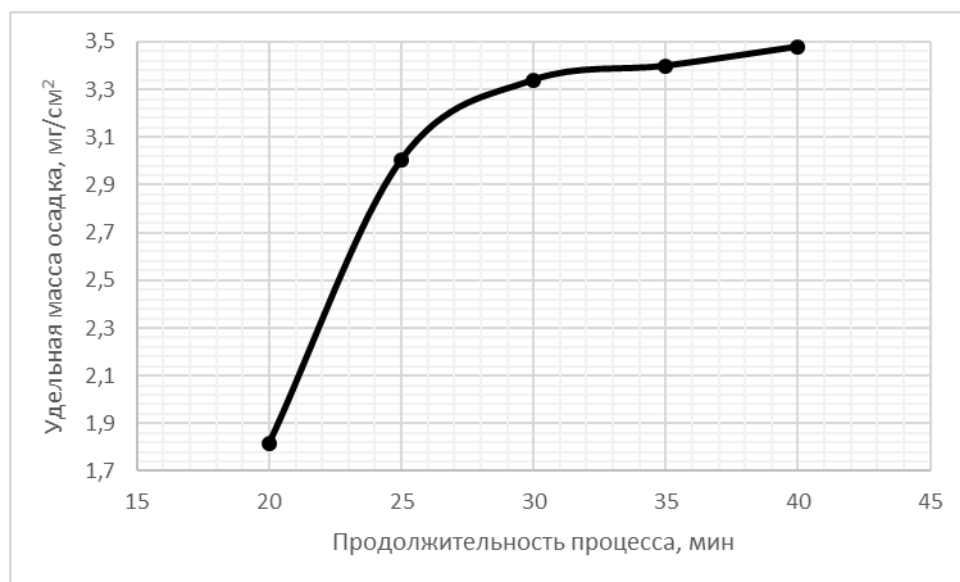
Рисунок 6.2.8. Влияние продолжительности процесса никелирования на удельную массу осадка.
