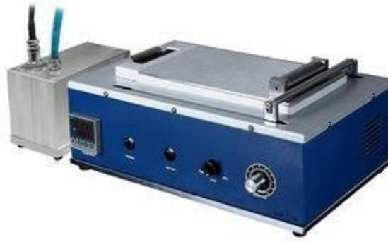
Рисунок 77 – Аппарата для намазки электродов химических источников тока
