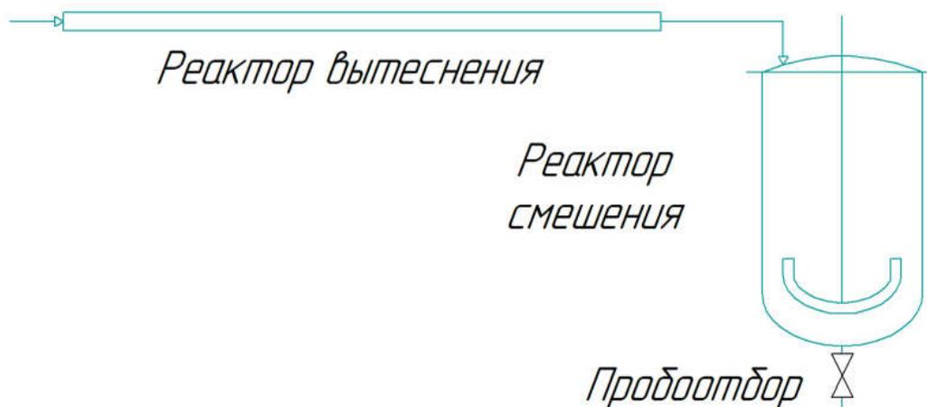
Рисунок 52 – Схема реакторов лабораторной установки
