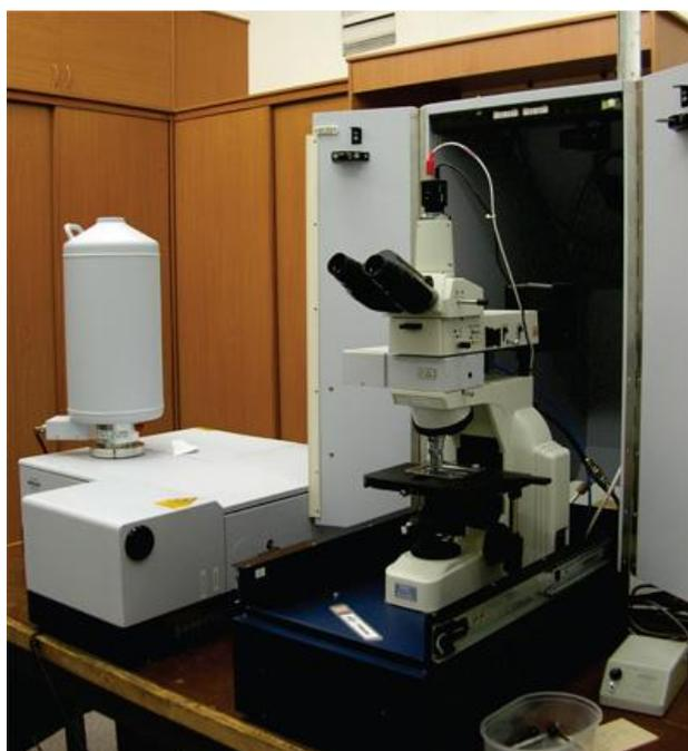
Рисунок 32 - Спектрометр комбинационного рассеяния Bruker RFS 100/S
