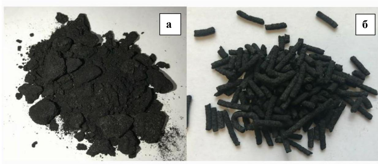
Рисунок 38 - Внешний вид порошкового АУ-О2-Опт (а) и гранулированного АУ-О2-Г (б) активных углей
