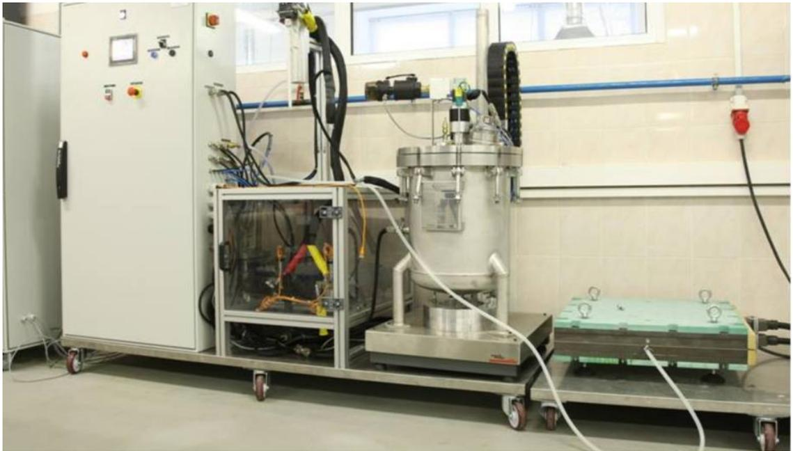
Рисунок 5 - Установка для изготовления полимерных композиционных материалов с отсеками для вакуумной инфузии и пропитки под давлением (ФГУП «ВИАМ») [36]
